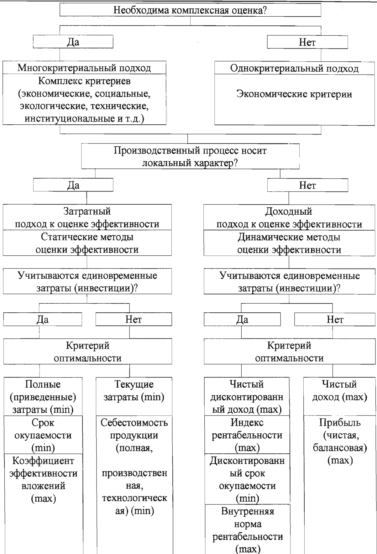
Рис. 2. Принципиальная схема выбора критерия эффективности проекта организации производственного процесса
