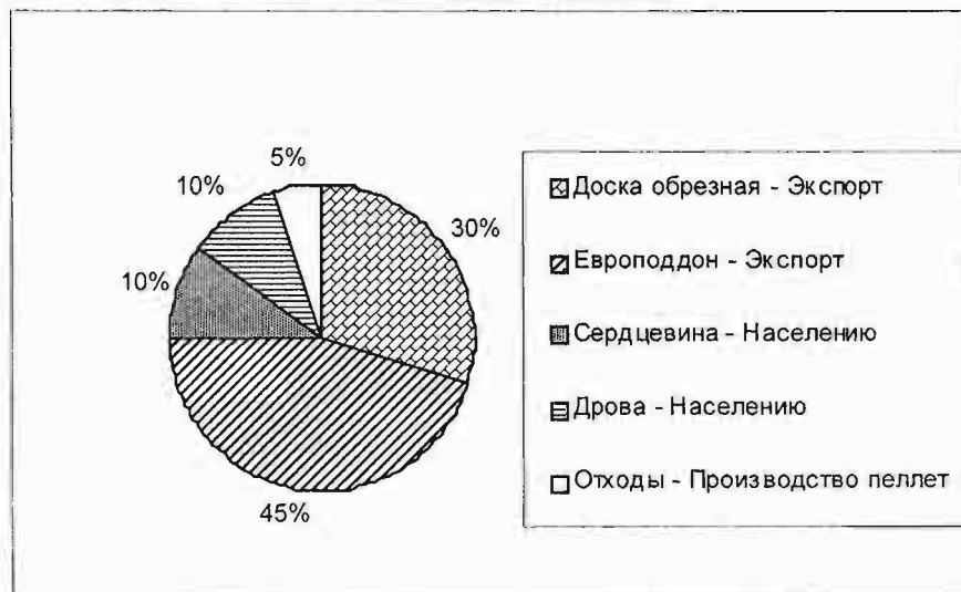
Рисунок 4 – Выход продукции из 1 м³ пиловочника на ОДО «Элефант»
