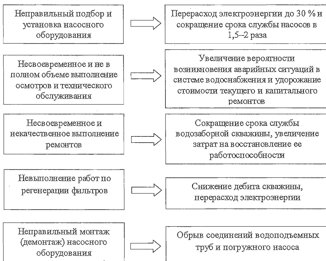
Рисунок 2 – Основные проблемы и последствия неправильной технической эксплуатации водозаборных скважин
